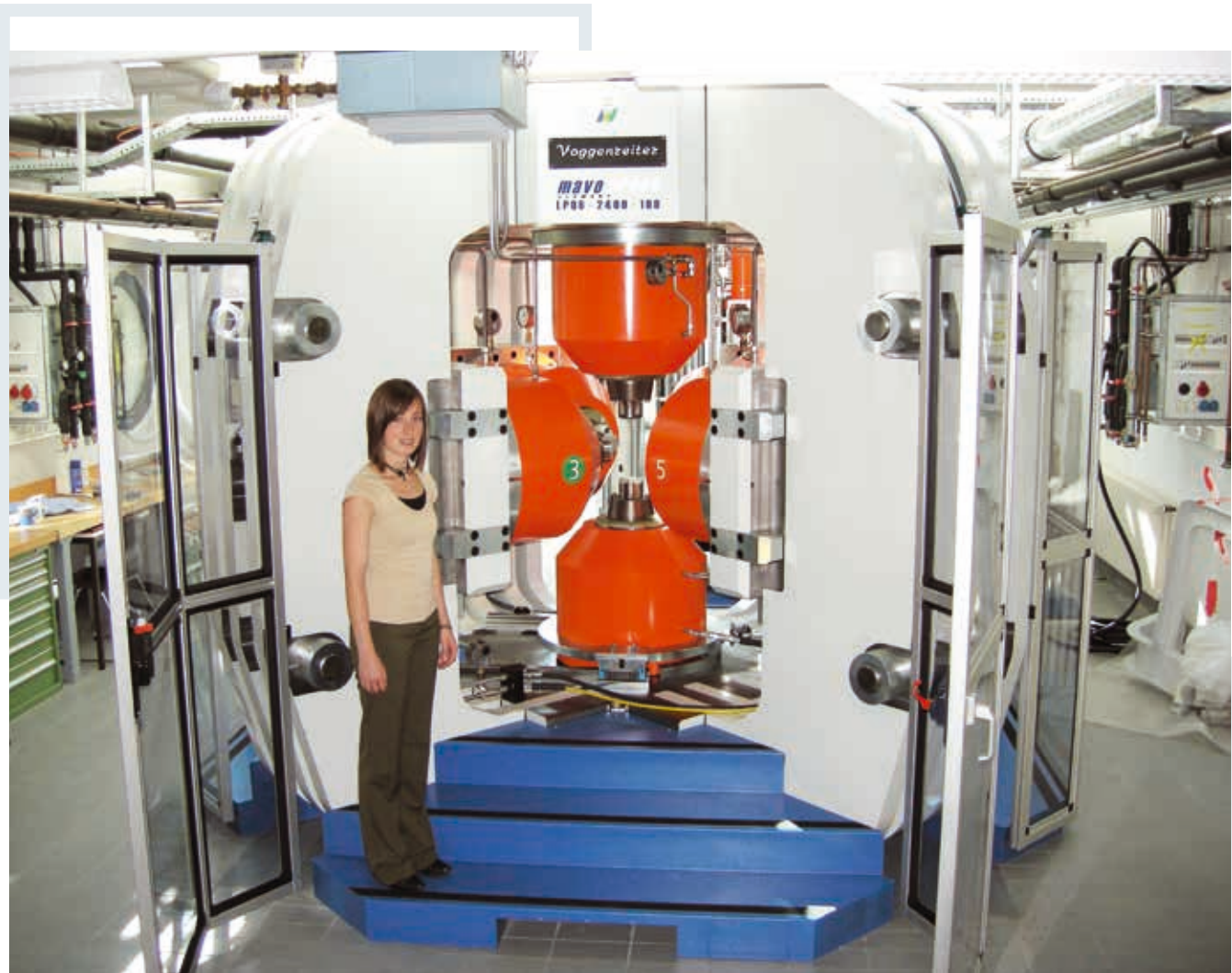
Eine der Hochdruckpressen im Labor des Bayerischen Geoinstituts.
